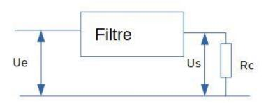
Un signal alternatif de tension Ue entre dans le filtre, une tension Us est mesurée aux bornes de la charge Rc
