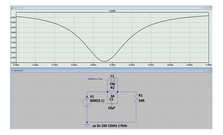
La tension de sortie est mesurée aux bornes de R1
