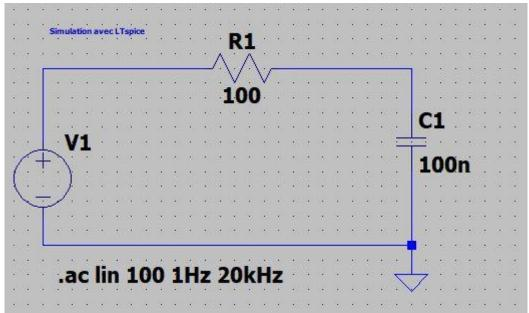
Le générateur V1délivre une tension alternative (5V) qui va varier de 1Hz à 20 kHz, c'est **l'entrée du filtre.**
