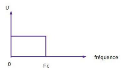
Le filtre passe bas idéal aurait cet aspect. La tension aux bornes du condensateur reste la même jusqu'à la fréquence Fc puis elle est nulle pour toute fréquence supérieure à Fc
