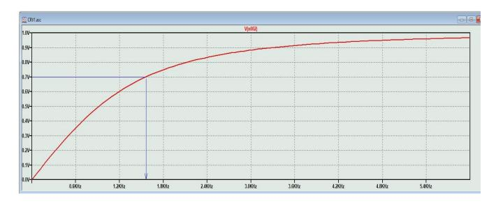
La tension du générateur a été fixée ici à 1V alternatif On voit que vers 0,7V (70% de 1V) la fréquence de coupure correspondante est environ 1,5 - 1,6 kHz
