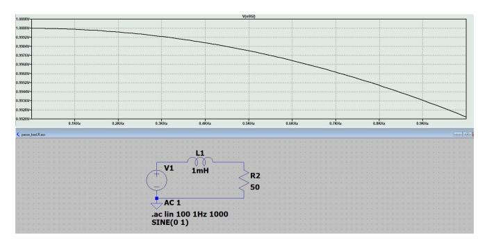
La tension de sortie du filtre est mesurée aux bornes de R2
