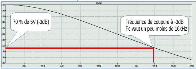
On étudie la tension de sortie en fonction de la fréquence d'entrée dans le filtre. On voit que pour des fréquences inférieures à 2 kHz environ, la tension en sortie de filtre est toujours d'environ 5V, puis diminue progressivement.
