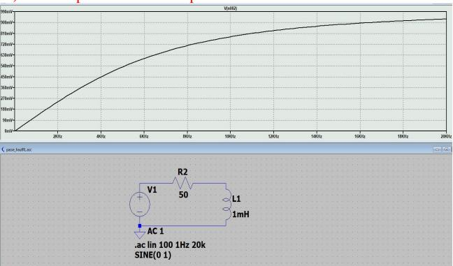
La tension de sortie du filtre est mesurée aux bornes de L1
