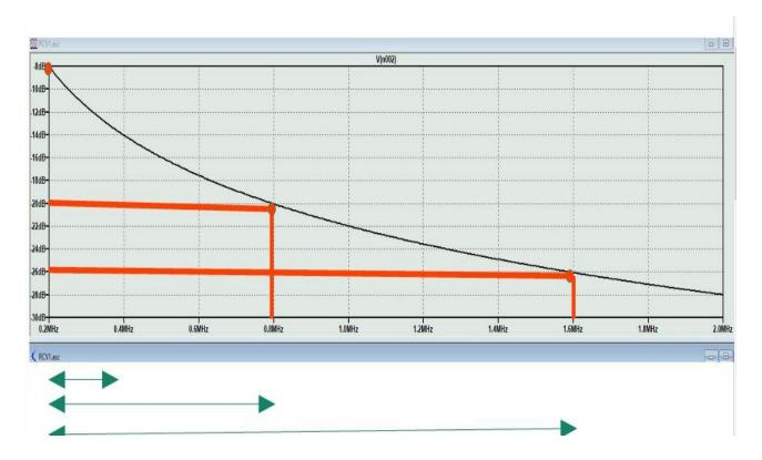
L'atténuation de la tension aux bornes du condensateur en fonction de la fréquence d'entrée du filtre a été exprimée maintenant en dB.
