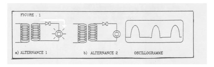
Alternance 1 : la diode est dans le sens passant (durant le temps d'une demipériode), la lampe s'allume.
