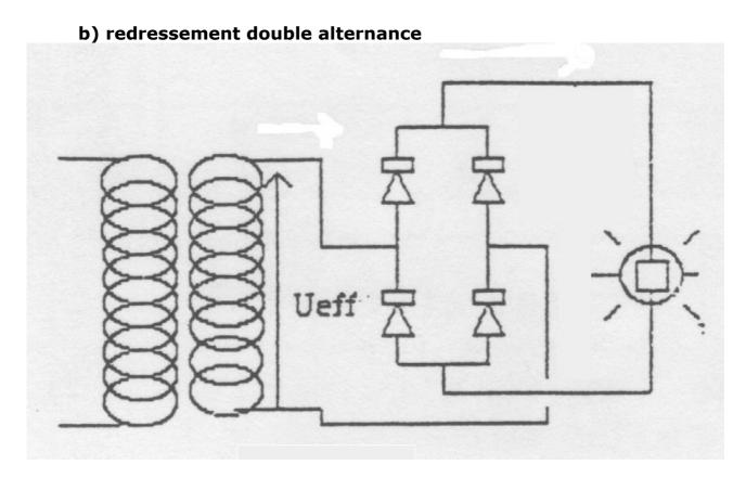
On utilise pour cela un pont de 4 diodes placées judicieusement (pont de Graëtz). Pendant une alternance, le secondaire du transformateur possède une borne + et une borne - (voir schémas ci dessous). Le courant va
