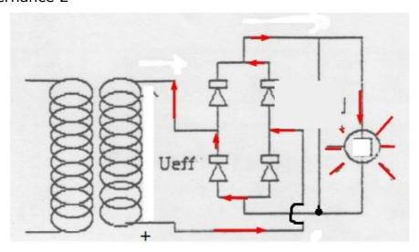
Pendant l'autre alternance, la borne + du secondaire du transformateur a changé (voir schéma). Le courant va donc se déplacer de la borne + et se diriger vers la borne - de la bobine. Il traverse la lampe ici de haut en bas également.
