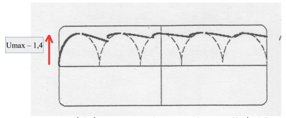
**Remarque**: en réalité, pour trouver la tension de sortie filtrée il faut retirer de **Umax (sortie) - 1,4 V** (deux fois 0,7V, la chute de tension aux bornes des deux diodes passantes)
