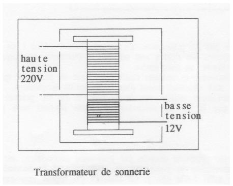
Ce transformateur de sonnerie est composé de deux enroulements (bobines ) de fil de cuivre, **sans aucun contact l'un avec l'autre**. On applique la tension du secteur (Ueff = 220V) à l'enroulement qui a le plus grand nombre de spires et on mesure une tension alternative de Ueff = 12V efficaces environ sur la bobine qui a le plus petit nombre de spires. Il n'y a pas de liaison entre les deux bobines, comment expliquer ce phénomène ?
