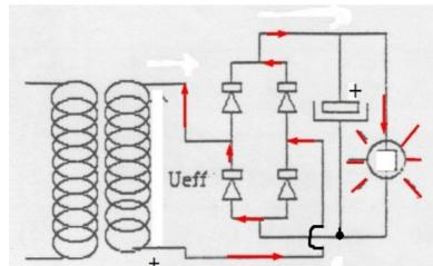
Le condensateur chimique polarisé de forte valeur se charge quand la tension augmente, puis se décharge dans la lampe quand la tension diminue. C'est un condensateur de filtrage. On obtient l'oscillogramme suivant :
