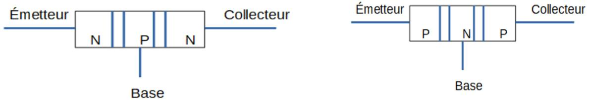
Un transistor bipolaire est constitué par un cristal dopé de façon à former :
