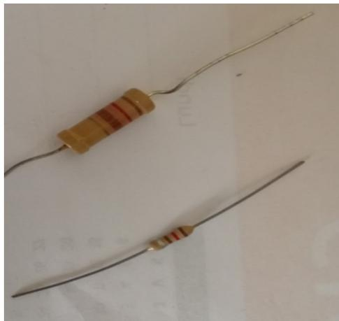
Sur la photo ci-dessus, voici deux résistances de  $120\ \Omega$ , la petite est une «  $1/4W$  » ce qui signifie qu'elle ne doit pas dissiper une puissance supérieure à  $1/4W$ , au-delà, elle sera détruite.
