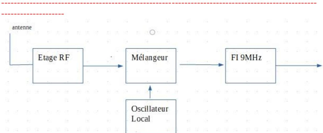
La fréquence à recevoir est 14.2 MHz, quelle est la fréquence
