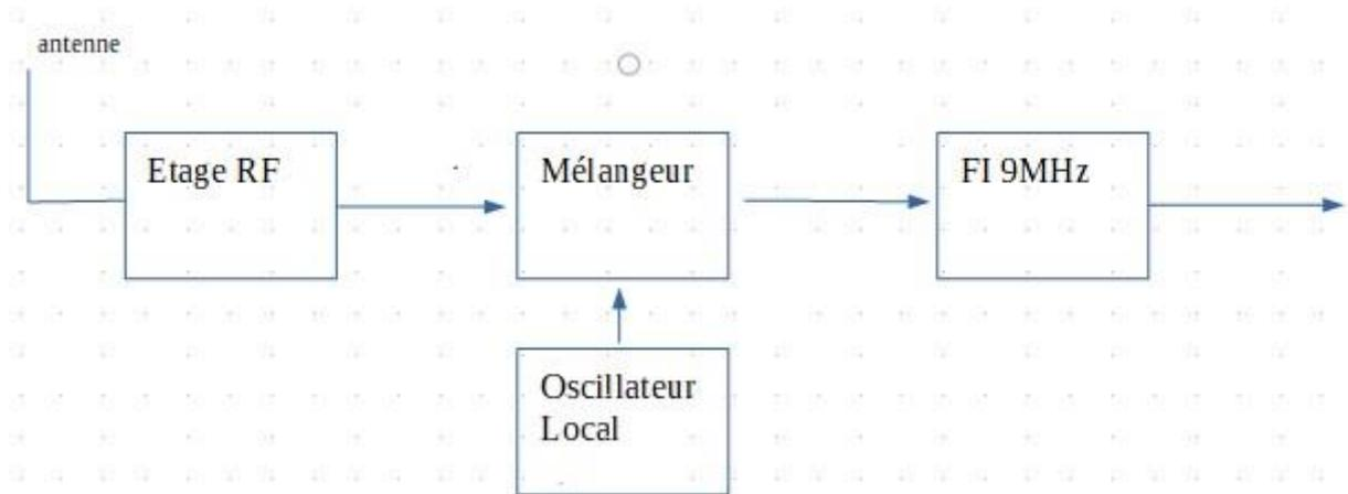
La fréquence à recevoir est 21,2 MHz - sur quelle fréquence doit être réglé l'oscillateur local ?
