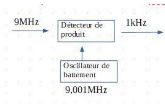
Ce montage est utilisé pour démoduler
